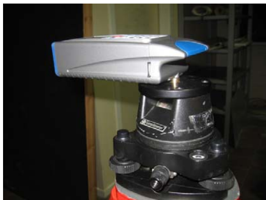
Figur D1. Längdmätaren monterad en trefot.
