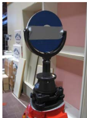
Figur D2. Mål för EDM-testets längdmätningarna (vridbar halv-sfär)
