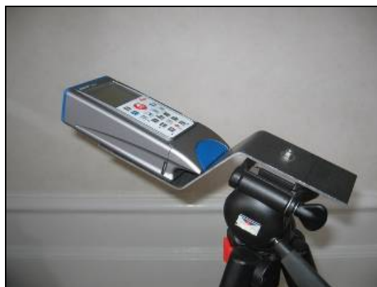
Figur 2.6. Längdmätaren Leica Disto Plus monterad med adaptern på kamerastativet.
