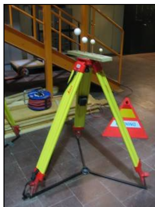
Figur 2.4. En markörgrupp monterad på en bräda som i sin tur är monterade på ett stativ med stativstjärna.
