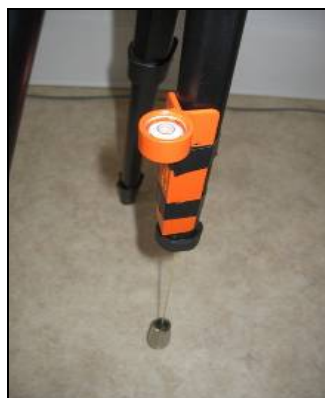
Figur 2.8. Doslibell och snörlod monterat på kamerastativets mittstång.
