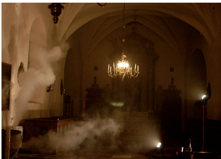
Figur 9. En rökgenerator användes för att visualisera luftrörelserna ut från värmepumparna.
