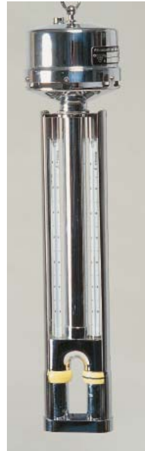
Assmannpsykrometer. Båda termometrarna är numererade och certifierade.
