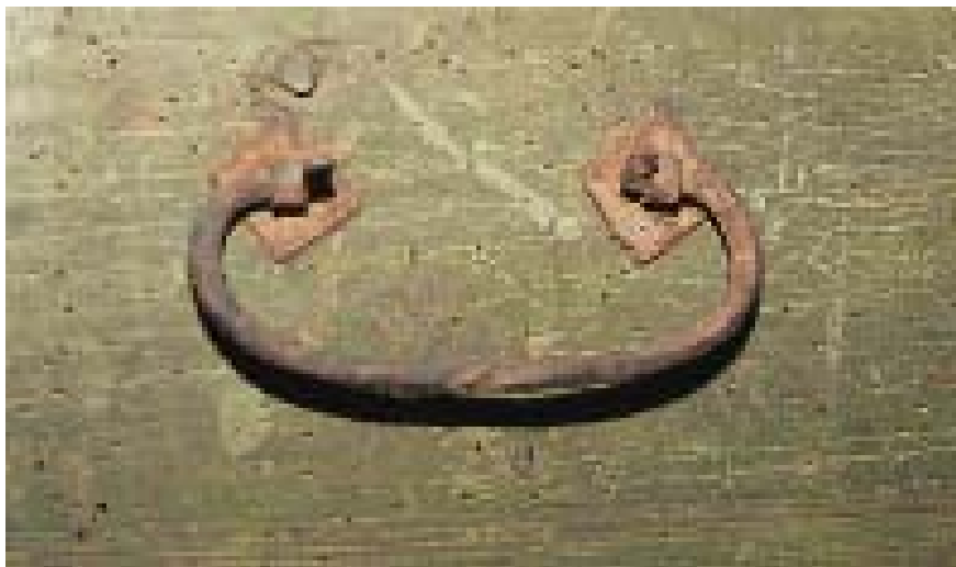
Målad kista med handtag. Runt handtaget finns många flyghål efter trädgnagande insekter. Träet är försvagat och skulle sannolikt brista, om någon försökte lyfta i handtaget.
