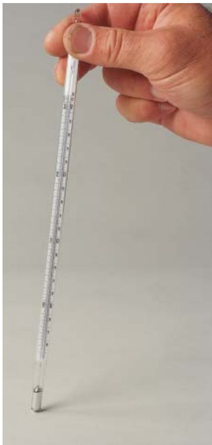
Kvicksilvertermometer med skalan delad i 0,1°C.
