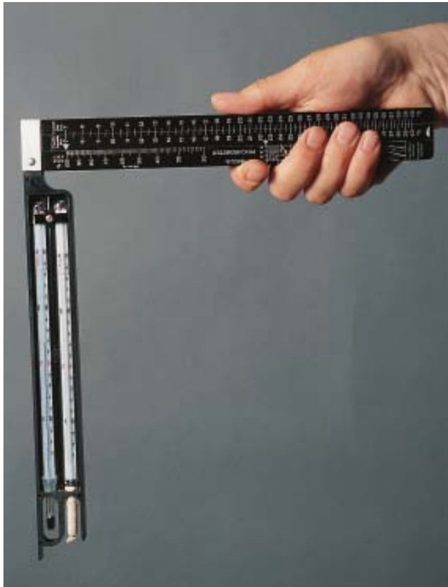
Slungpsykrometer. Två certifierade termometrar, den vänstra torr, den högra med fuktad bomullsstrumpa. Temperaturskillnaden ger den relativa luftfuktigheten.
