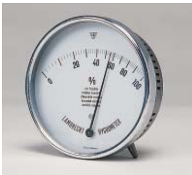
Hårhygrometer. Sådana instrument bör fuktas på nytt genom att ligga i en fuktig handduk i en timme varje vecka.
