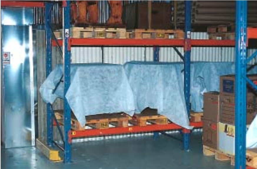
Förvaring av möbler i ett pallställ. Pallstället är uppställt så att det går att städa under det. Möblerna är täckta för att skyddas mot luftburna partiklar.
