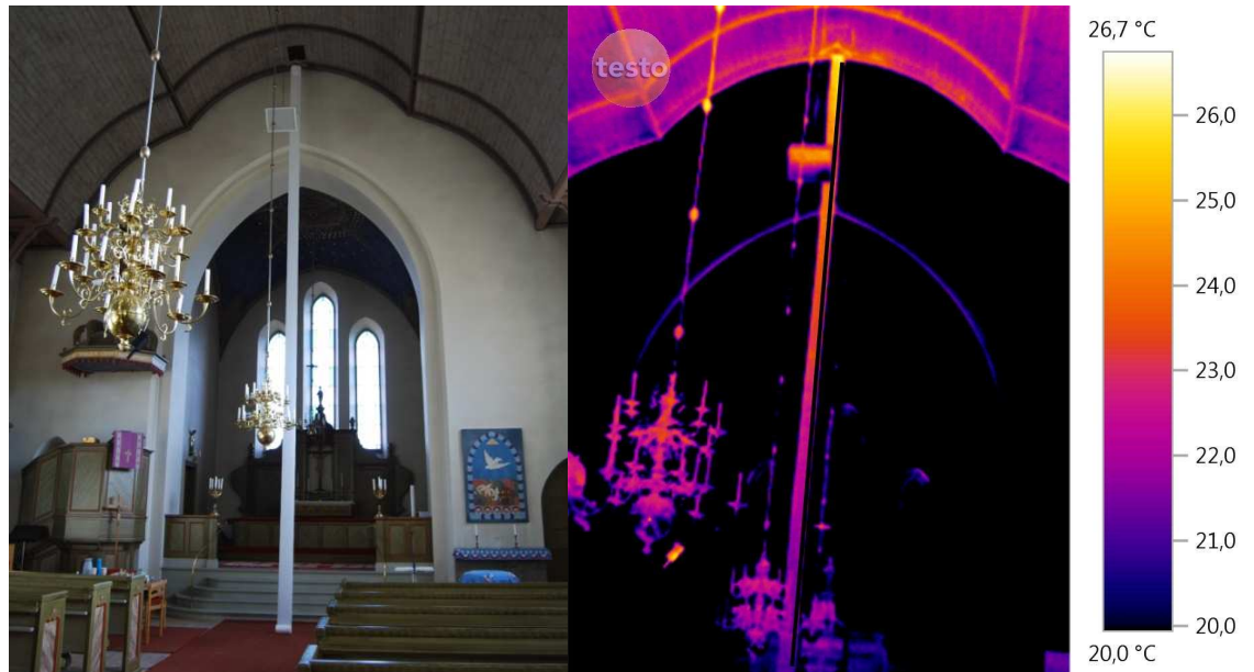
Bild 5: Ett papper hängdes upp från golv till tak för att kunna mäta lufttemperaturen i höjdlängd med hjälp av värmekameran.
