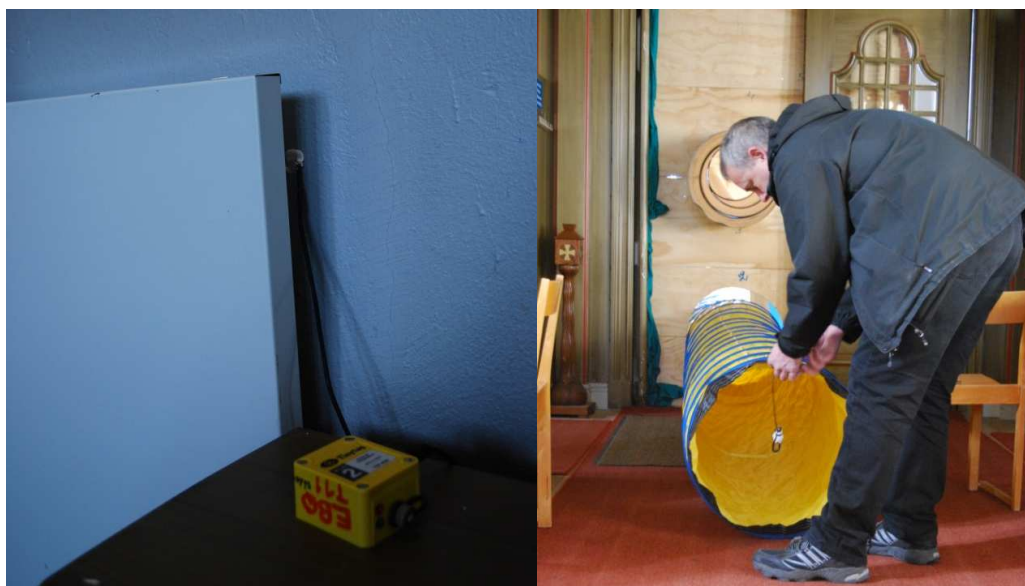
Bild 3 och 4: Logger som mäter ytemperatur på vägg. Temperatur och RF på varmluften mättes.
