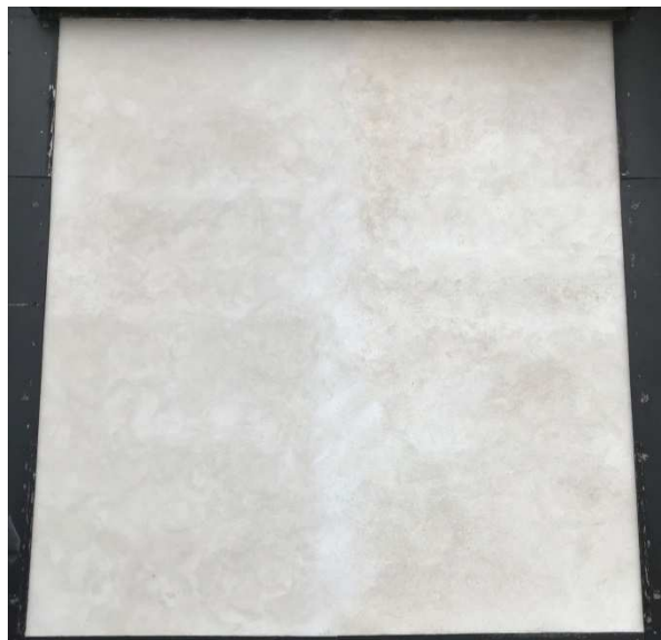
Figur 19. Puts bestående av dels NHL-kalkbruk (t.v.) och dels luftkalkbruk (t.h.). Foto: Paulien Strandberg
