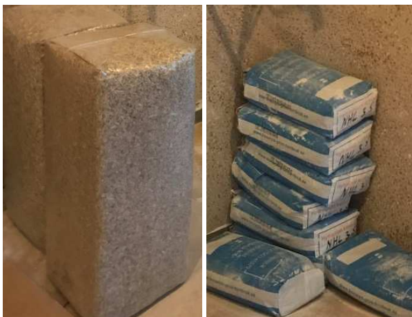
Figur 16. Hampaskävor på bal och NHL-kalk i säck. Foto: Kristin Balksten
