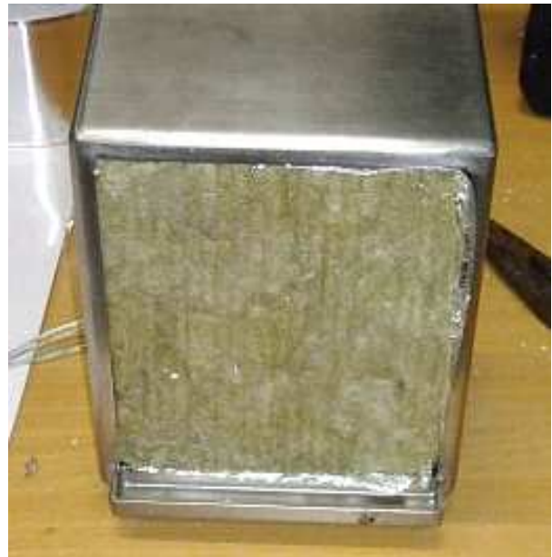
Figur 1. Provbit av stenull placerad i provform av stål inför försök.
