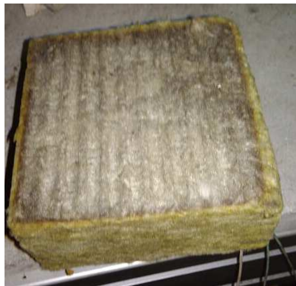
Figur 3. Provbit av stenull efter försök med den högsta strålningsnivån som testades.
