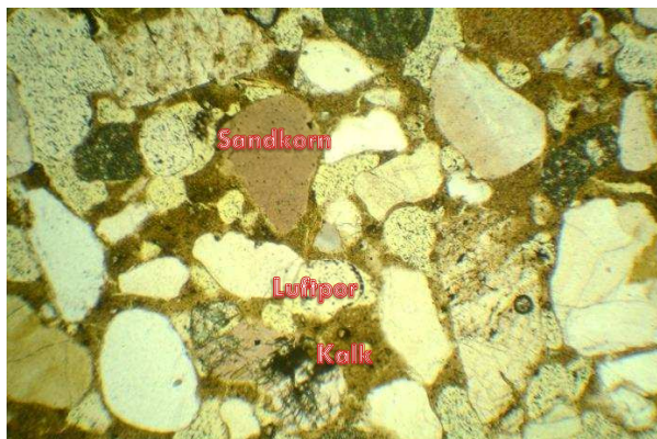
Figur 29. Prov 3Speckrum visar ett av de magrare bruken med blandningsförhållande ca 1:2 mellan kalkpasta och sand.
