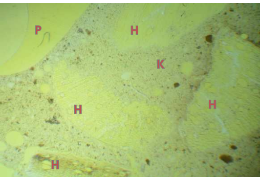
Figur 10. Hampakalk uttaget på 115-130 mm djup i vägg A, dvs närmast teglet. Polarisationsmikroskopbild av tunnslipet visar, liksom i föregående bild, en homogen kalkmassa (K) som omsluter hampaskävorna (H). I kalkmassan finns runda luftporer av varierande storlek (P), mestadels är de väl avgränsade från varandra utan förbindning via kapillärporer. I hampaskävornas fiberriktning syns även dess egna porstruktur som följer fiberriktningen. Nederkant varje foto visar 2,65 mm av provet.
