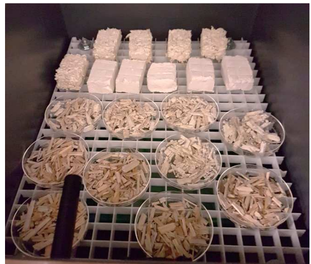
Figur 2. Provkroppar placerade i klimatlåda. Uppifrån syns hampakalk, därefter ren kalk, fina hampaskävor, grova hampaskävor och i mitten till höger hampaskävor med ett tunt kalkskikt. Foto: Sanne Johansson
