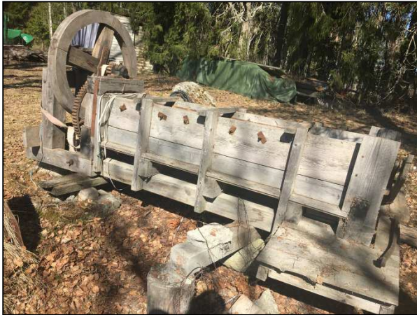
Figur 6. Lertegelmaskin från gården Blanks i Kalvhaga, Hälsingland. I karet hälls lerblandningen. Det runda trähjulet driver järnaxeln som blandar lermassan. I hålet längst till höger under karet ställs en tegelform. Den skjutsas in från ena sidan och kommer ut på den andra, fylld med välpackad lerblandning. Formen lossas därefter försiktigt och dem välformade massan lägg i solen för att torka. Foto: Ellen Olsson.
