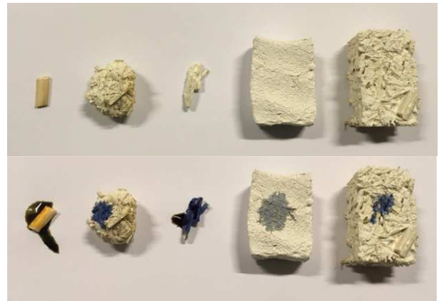
Figur 1. Provkropparna tillverkades en tid innan mätningen skulle påbörjas så att de hann genomkarbonatisera före mätning. Karbonatiseringen påvisades med indikatorämnet tymolblå. Foto: Paulien Strandberg
