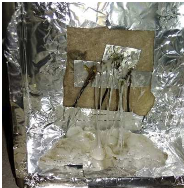
Figur 4. Provbit av cellplast efter försök med den lägsta strålningsnivån som testades.
