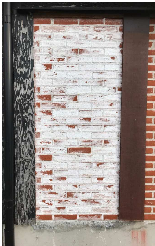
Figur 7. Provmur A, med det extrema saltinnehållet som syns på ytan.
