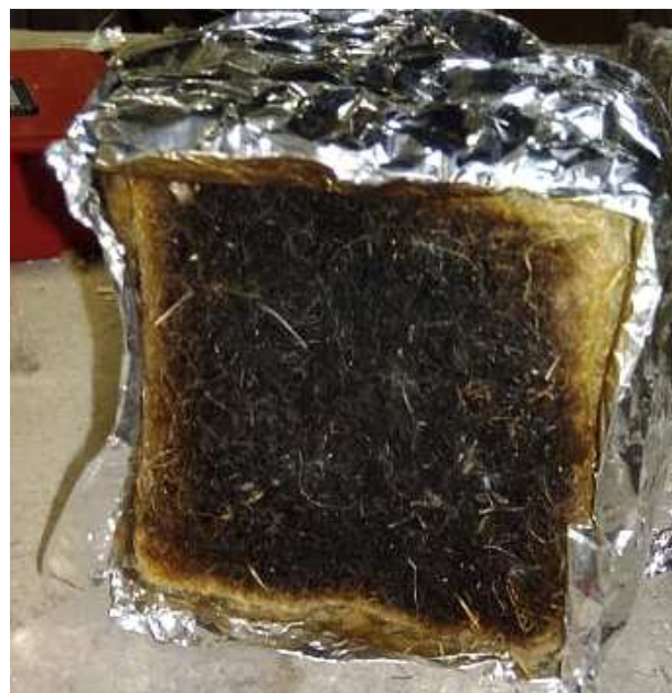
Figur 7. Provbit av linullisolering efter försök med den lägsta strålningsnivån som testades.
