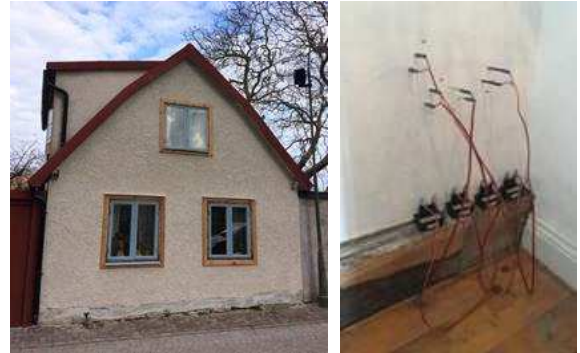
Figur 11. Byggnaden efter putsens färdigställande. Mätsondror för att logga fuktnivåer i väggen har satts in från insidan på övervåningen. Foton: Paulien Strandberg-de Bruijn
