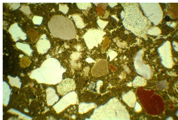
Figur 33. Prov 4Biskopen, ett homogent kalkbruk med en något grynig kalk, ca 1:1,5.
