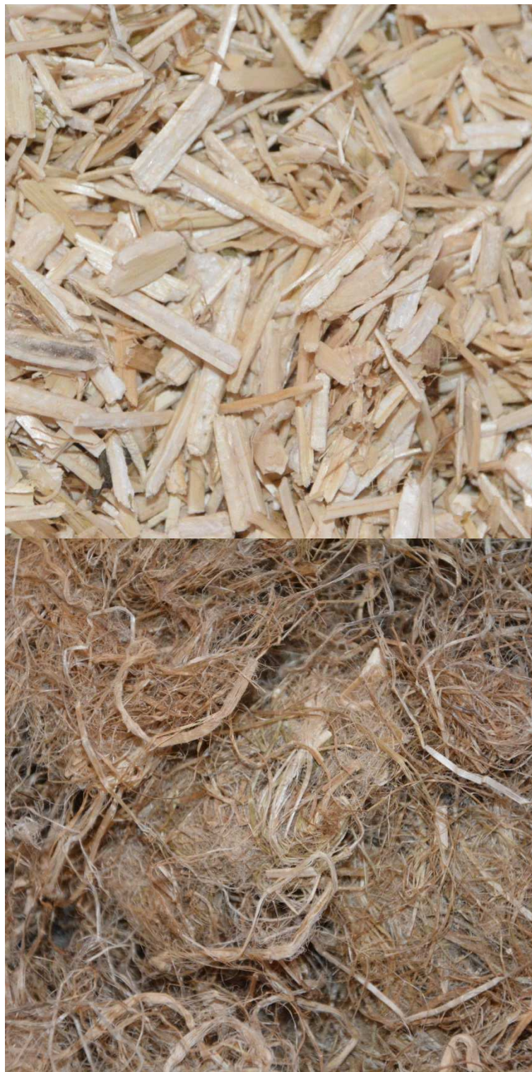
Figur 4-5. Hampans vedämnen, skävor syns i övre bilden och hampans fibrer så som den ser ut när den används till hampafiberisolering syns i nedre bilden. Foto: Kristin Balksten
