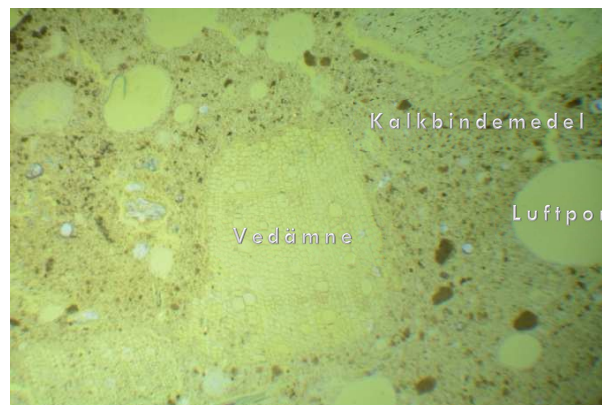
Figur 7. Hampakalk sett i genomskärning i polarisationsmikroskop visar hur hampans vedämnen omsluts av kalkbindemedel. Tunnslipet är tillverkat av Petrolab och analyserat genom polarisationsmikroskop Brunel SP-1500XP av Kristin Balksten. Underkant bild motsvarar 2,65 mm.
