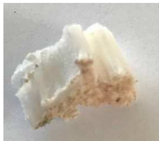
Figur 24. Makrofoto på kompakta halitkristaller
