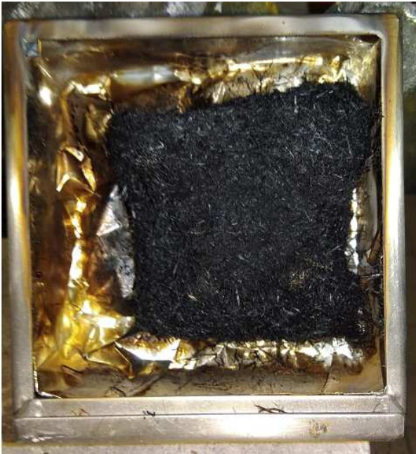
Figur 8. Provbit av träfiberisolering efter försök med den lägsta strålningsnivån som testades.
