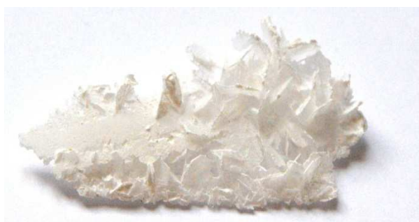
Figur 28. Makrofoto som visar kalcitkristaller som haft tid långsamt växa till på en yta med fri tillgång på kalciumhydroxid och vatten. De stora trigonala kristallerna är ca 5 mm.
