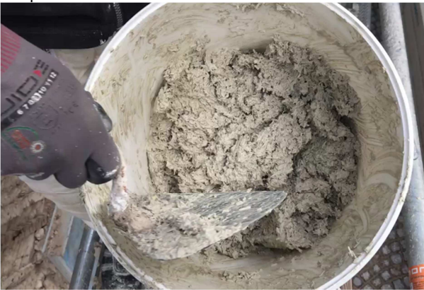
Figur 9. Hampakalkbruk som kan putsas för hand som ett vanligt styvt kalkbruk. Foto: Tom Yttergren
