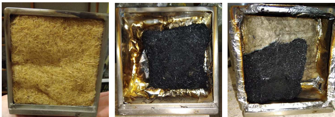
Figur 11. Träfiberisolering innan exponering, efter försök med 10 \text{ kW/m}^2 värmestrålning och efter försöket med 20 \text{ kW/m}^2
