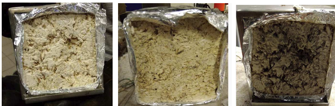
Figur 7. Hampakalken innan exponering, efter försök med 10 \text{ kW/m}^2 och efter försök med 20 \text{ kW/m}^2 värmestrålning
