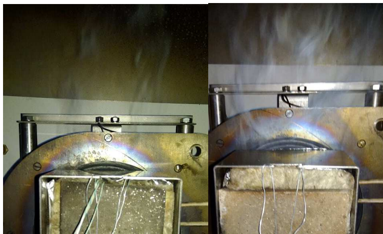
Figur 10. Rökbildning vid försöken med träfiberisolering, där 10 \text{ kW/m}^2 visas till vänster och 20 \text{ kW/m}^2 till höger
