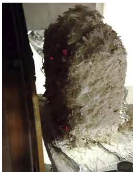
Figur 8. Hampakalk där yttersta kalkskiktet tagits bort och sedan utsatt för 20 \text{ kW/m}^2 värmestrålning
